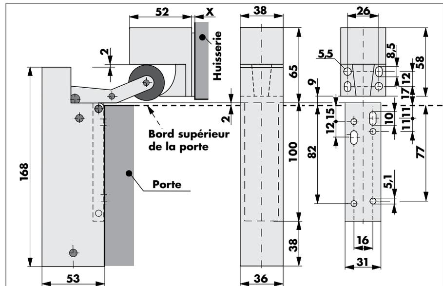
**Cote X :** Avec des portes à recouvrement il faut adapter le niveau du crochet. Les cales inclus (d'une épaisseur de 2, 3 et 10 mm) égalisent 2 jusqu'à 15 mm.
