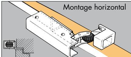
L'amortisseur de porte DICTATOR VS 2000 est monté au bord supérieur, normalement au milieu de la porte, à l'aide de sa plaque de montage pivotante. Le crochet est à la bonne hauteur quand le galet du bras abaissé de l'amortisseur touche de justesse au bord frontal du crochet. Important : avec des portes à recouvrement il faut utiliser les cales pour le crochet afin qu'il soit au même niveau que la plaque de base du ferme-porte.
