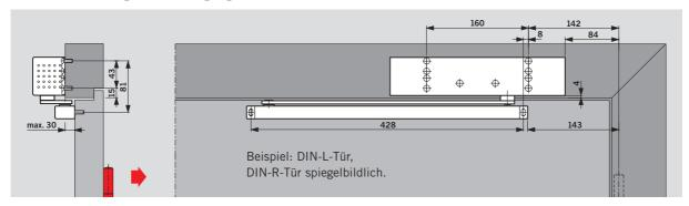
Sturzmontage (Kopfmontage) des DORMA TS 93 Basic auf der Bandgegenseite. Öffnungsdämpfung und Schließverzögerung sind bei dieser Montageart nicht wirksam. Abhängig von den baulichen
