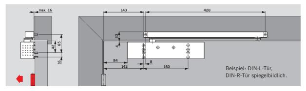
Türblattmontage (Normalmontage) des DORMA TS 93 Basic auf der Bandseite. Unter entsprechenden baulichen Voraussetzungen ist bei dieser Montageart ein Öffnungswinkel von 180° möglich. In den meisten Fällen ist dabei eine Wandausnehmung für den Türschließer vorzusehen.
