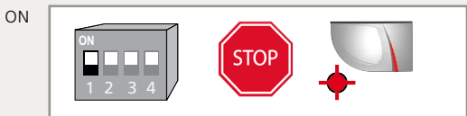
RELAIS 1: STOPP-Impuls auf Bandseite der Tür.
