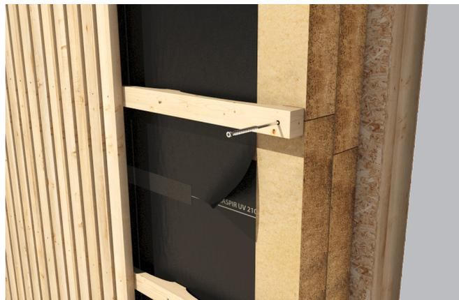
**Membrane synthétique à 3 couches ouverte à la diffusion de la vapeur pour l'application directe sur le côté froid du matériau d'isolation thermique. Indiquée pour la pose en façade même en cas de revêtement à joints ouverts grâce à sa résistance illimitée aux rayons UV.**
