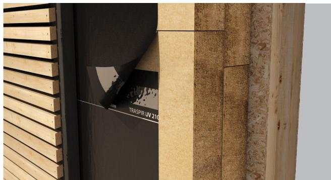
Membrana sintetica a 3 strati aperta alla diffusione del vapore per l'applicazione diretta sul lato freddo del coibente termico. Indicata per la posa in facciata anche con rivestimento a giunti aperti grazie alla sua resistenza illimitata ai raggi UV.
