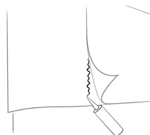
Scellement recouvrements de membrane à la colle
