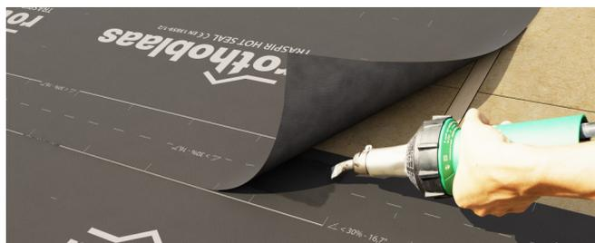
4-lagige diffusionsoffene Unterdeckbahn, bestehend aus zwei monolithischen TPEE-Lagen und doppelter rutschfester PET-Beschichtung zur direkten Verlegung auf der kalten Seite der Wärmedämmung. Einsetzbar ab einer Dachneigung von 5° und mit Einhaltung der Richtlinien für Fixiedeckung. Durch die hohen mechanischen Eigenschaften besonders für stark geneigte Dächer geeignet.
