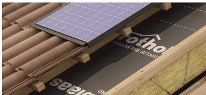
**Ecran de sous-toiture HPV composée d'une couche de renfort en PL et revêtement fonctionnel en PU avec Euroclasse de réaction au feu B-s1,d0. Résistance illimitée aux rayons UV.**
