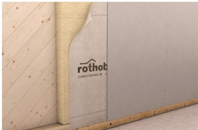
**2-lagige variable Dampfbremse aus PA und PP-Vlies zur direkten Verlegung auf der warmen Seite der Wärmedämmung an Wänden und Dächern. Variabler Sd - Wert 0,2 m bis 20 m.**
