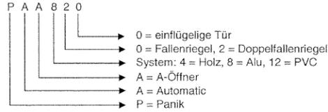
Die Schlosstypen PA 400 – 1220 können mit autarker Zusatzfalle am Langstulp in Kombination mit Fluchttüröffner EFF-EFF 332 als elektrisch verriegeltes Panikschloss (Security EVP) betrieben werden. Die Panikfunktion ist nur bei freigeschaltetem (spannungslos) Türöffner EFF-EFF 332 gewährleistet. (Dann nur VS-TYP B)
