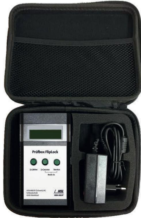
Die Prüfbox dient zur Überwachung und Wartung der motorischen FlipLock-Linie. Damit lassen sich unkompliziert und einfach verschiedene Betriebsmodi und Zustandswerte des Schlosses abrufen und überprüfen. Die Prüfbox wird direkt an das Anschlusskabel des ein- oder ausgebauten FlipLocks angeschlossen.
