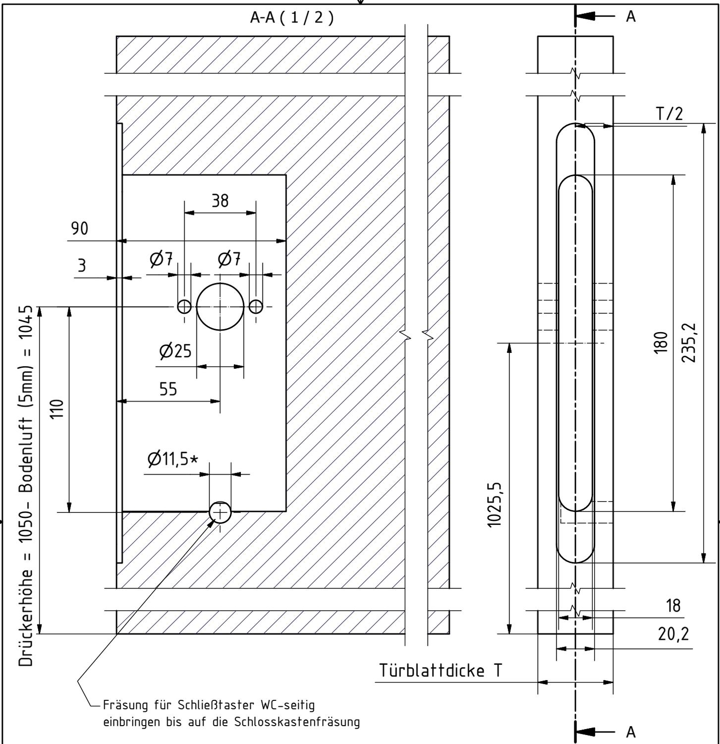
Drückerhöhe = 1050 - Bodenluft (5mm) = 1045
