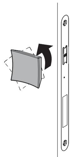
Die Tür ist nun entsperrt und kann geöffnet werden. Den Vierkant nach dem Öffnen wieder in die Ausgangsposition zurückdrehen!
