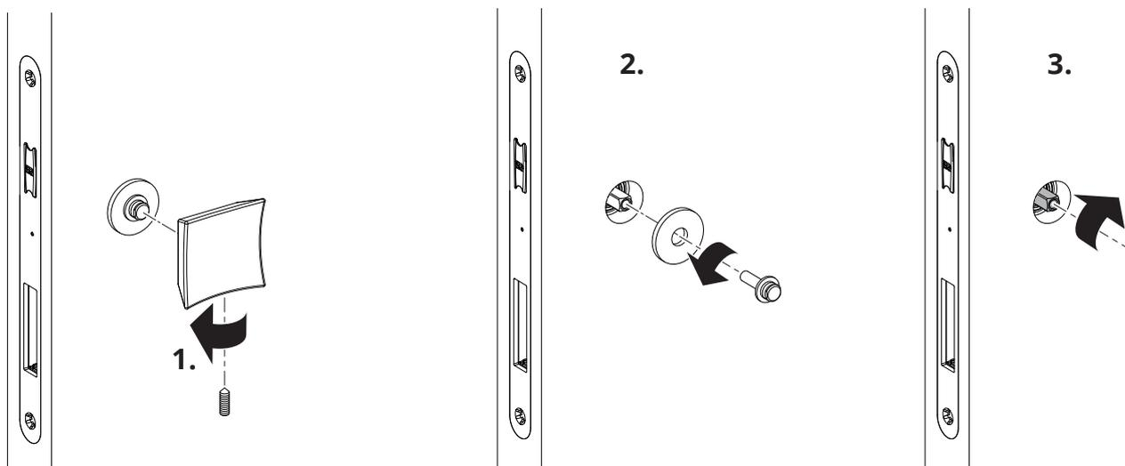
Die Tür ist nun entsperrt und kann geöffnet werden. Den Vierkant nach dem Öffnen wieder in die Ausgangsposition zurückdrehen!
