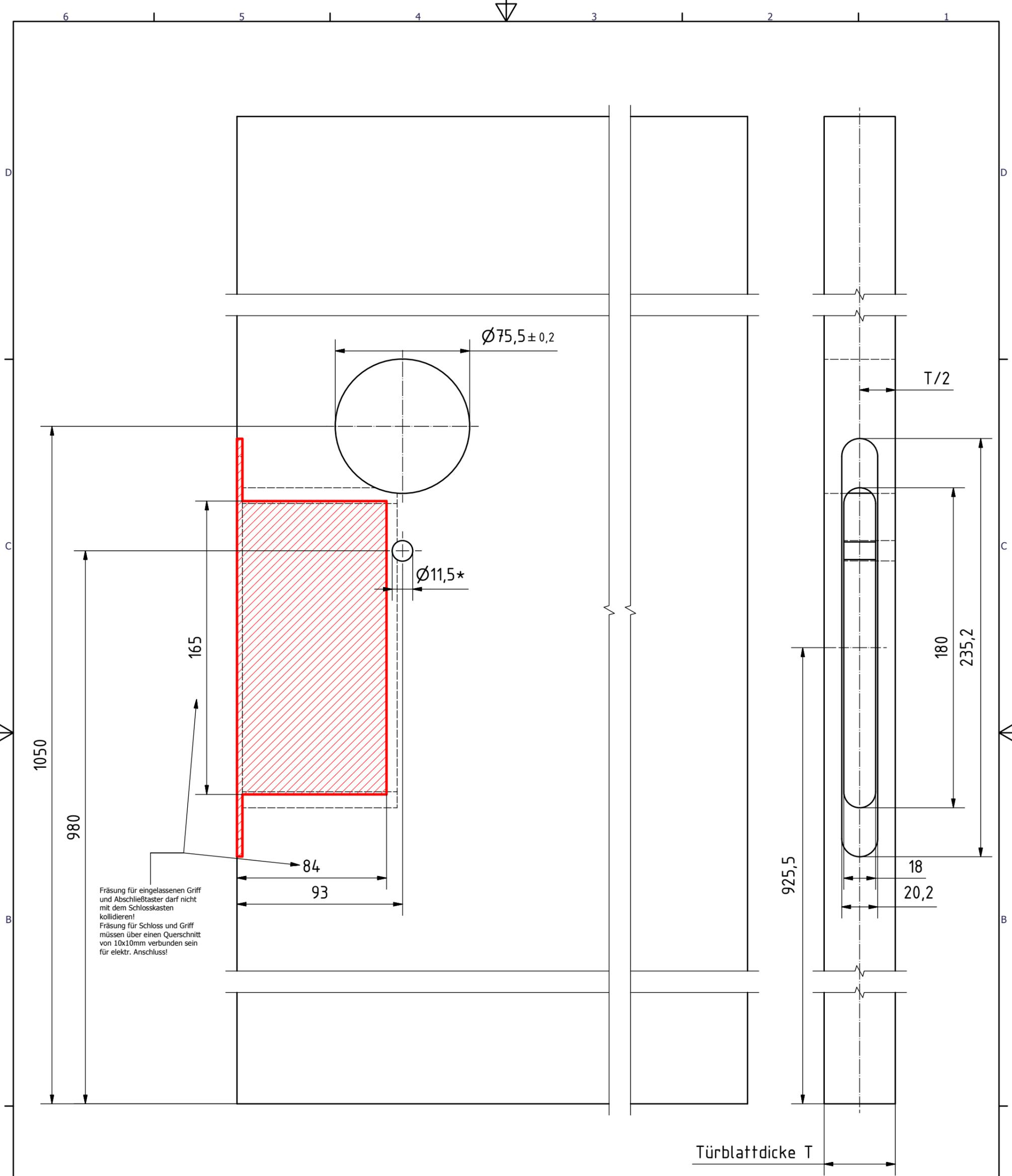
\* gilt nur bei Wabenfüllung und Röhrenspansteg. Bei Vollholz:  $\varnothing 12$  mm
