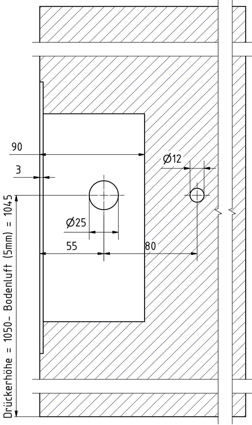
Drückerhöhe = 1050 - Bodenluft (5mm) = 1045
