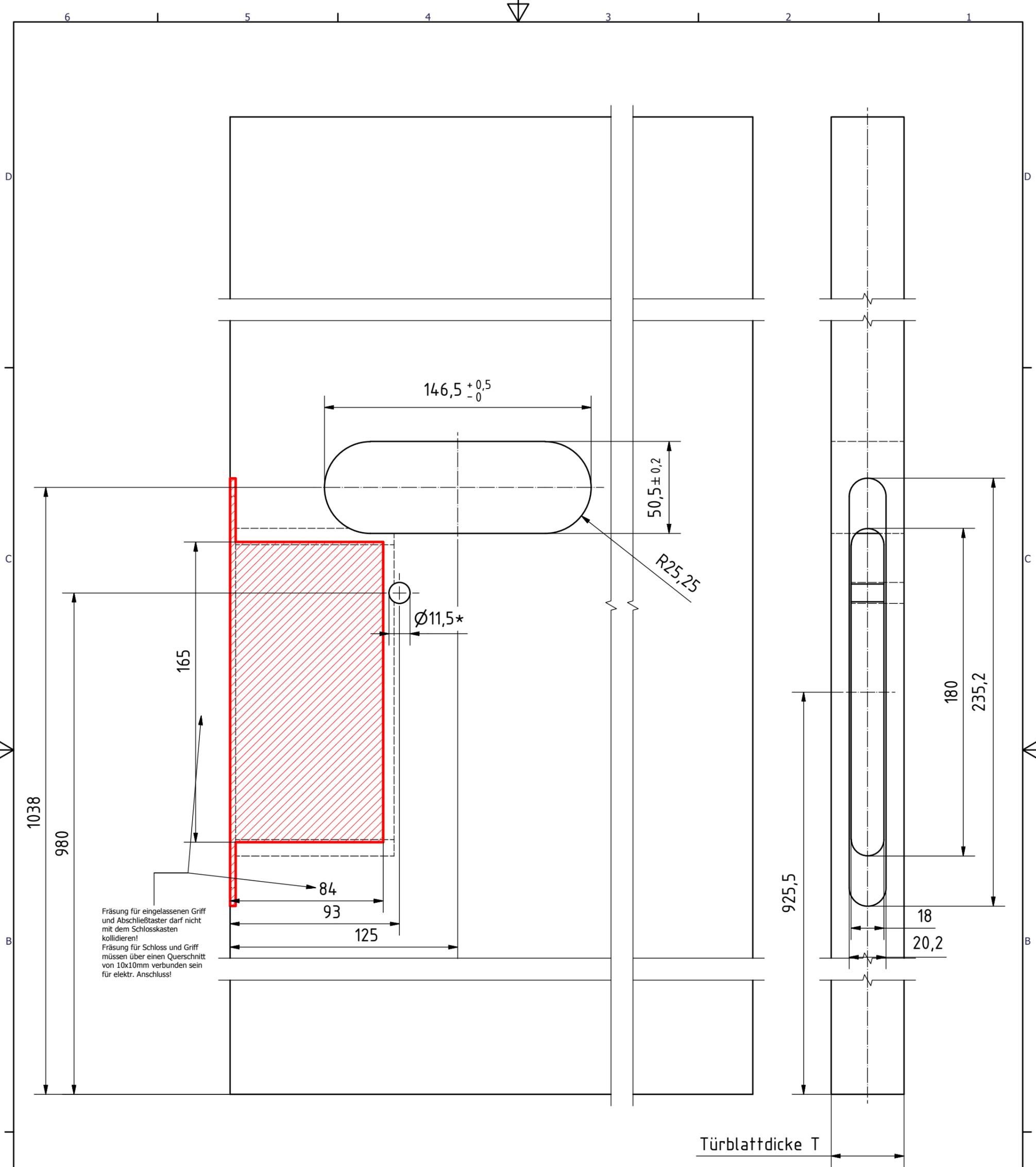
\* gilt nur bei Wabenfüllung und Röhrenspansteg. Bei Vollholz:  $\varnothing 12$  mm
