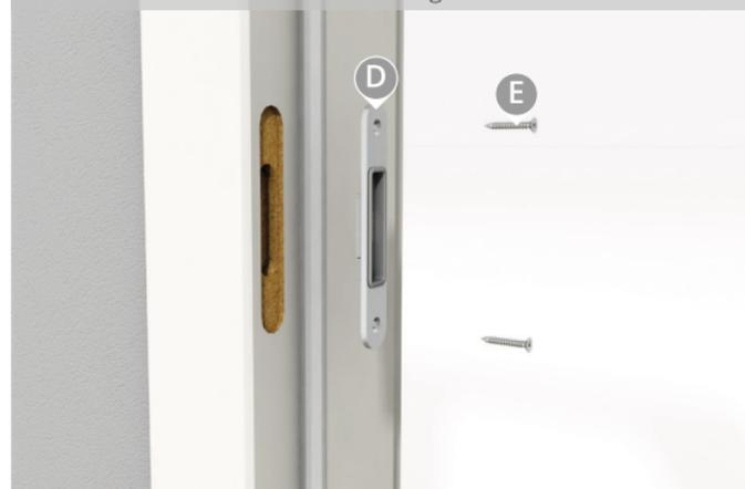
HINWEIS: Durch das Drehen der Hinterfütterung kann das Spiel der Falle um 1mm variiert und der Anpressdruck angepasst werden.
