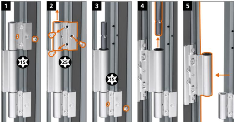
Markierung am Buchsenkragen zeigt oben und unten am Flügelband nach der Verstellung:
