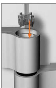
Verstellstern im oberen Rahmenbandteil positionieren.
