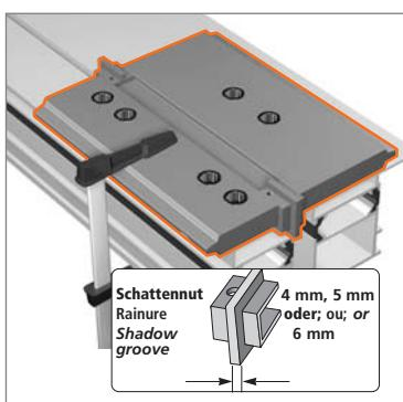
Bohrlehre mit Markierung „oben“ festklemmen, DIN links/DIN rechts beachten. Schattennut gemäß Einbauziehnung und Systemvorgabe sichern.
