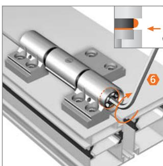
Hebespindel einschrauben, bis Lagerbuchse in Null-Stellung.
