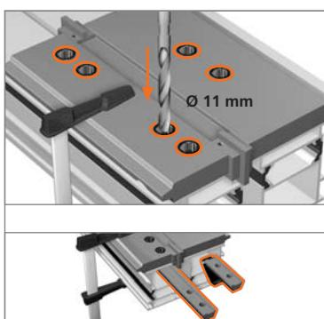
Ø 11 mm bohren – durch mindestens zwei Profilwandungen.
