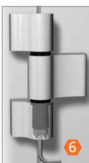
Mit Verstellstern untere Lagerbuchse um  $\pm 90^\circ$  drehen bis sie spürbar einrastet.
