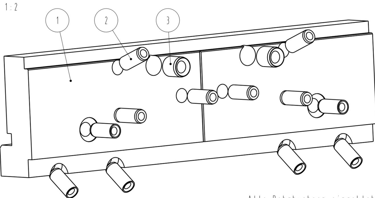
Alle Bohrbuchsen eingeklebt.
