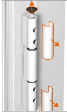
**Hülsen an beiden Rahmenbandteilen entfernen.**
