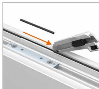
Anschlagdichtung unter Band zurückschneiden.
