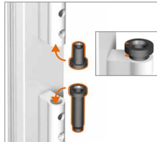
Lagerbuchsen einsetzen, Markierung zeigt zum Profil (Nullstellung).
