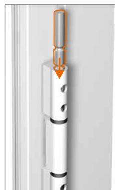
Bolzen von oben durch beide Bandteile bis Anschlag einführen.
