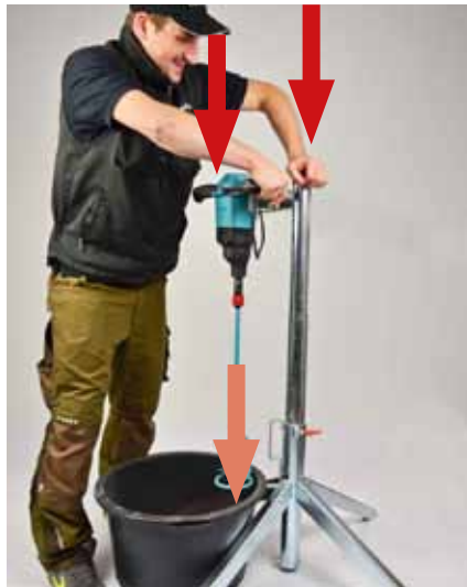
Zum Mischen Maschine in das Mischgut drücken. Damit Sie leichter in den Eimer kommen, zu Beginn mit der zweiten Hand unterstützend auf das Hubrohr drücken und das Rührwerk möglichst nah am Hubrohr halten.
