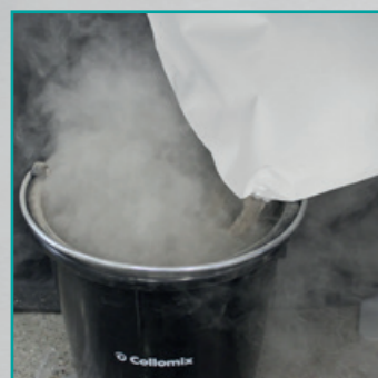
Durch das Umfüllen in den Eimer entsteht eine nicht unerhebliche Menge an Staub.
