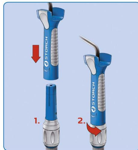
Aufsteck-Bügel auf den Teleskop-Verlängerungsstab aufstecken, Arretierung des LOCK-IT Systems durch einfaches Zudrehen des Arretierings
