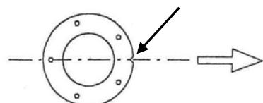
Kerbe zur Ausrichtung von Freiarmschirmen. Die Kerbe in Richtung Sitzplatzmitte ausrichten!
