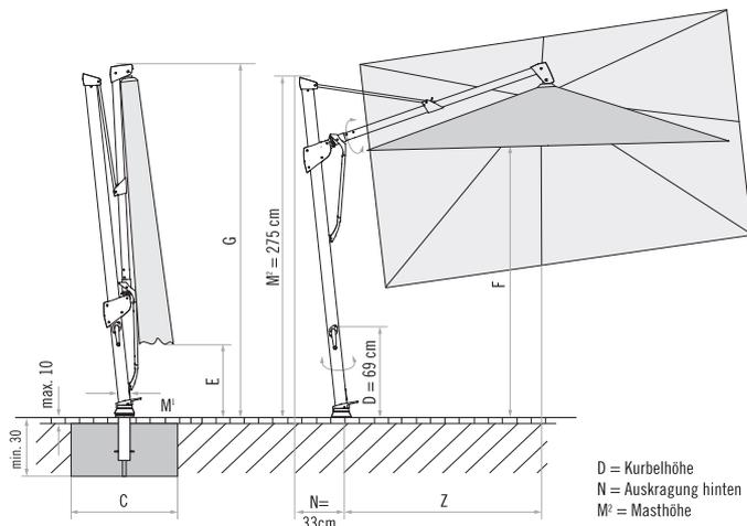
Loser Deckbelag max. 10 cm, Betondecke min. 30 cm (Frosttiefe beachten), Wasserabfluss.
