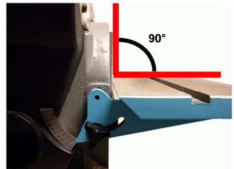
Stellen Sie den Abstand vom Tisch zum Schleifteller max. 2 mm ein. Als einfaches Hilfsmittel können Sie einen 1,5 mm Inbusschlüssel verwenden.
