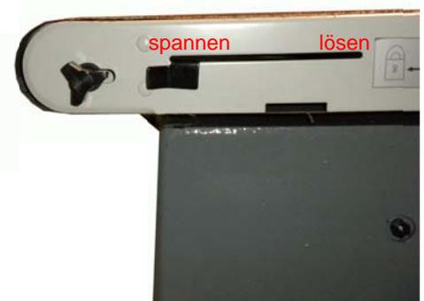
Mit dem Justierknopf können Sie nach dem korrekten Spannen des Bandes den korrekten Lauf einstellen. Drücken Sie die Starttaste und sofort wieder die Stoppaste. Beobachten Sie nun in welche Richtung das Band verläuft und korrigieren Sie entsprechend am Knopf in Uhrzeiger-oder Gegenuhrzeigerrichtung. Verstellen Sie nur fein und beobachten das Band.
