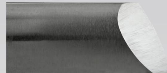
Das Schlüsselwort für das Tormek Schleifsystem ist Wiederholbarkeit. Die Werkzeuge werden mit Hilfe von Vorrichtungen geführt – nur ein geringe Menge von Stahl wird bei jedem Schleifen abgeschliffen.
