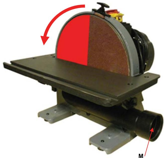
Anschluss Absaugrohr (M)
