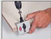
2. Die Bohrerle wird in die Nut geschoben und die Bedienungsöffnung gebohrt
