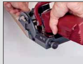
1. Mit der Lamello Zeta P2 wird die Profilnut gefräst
