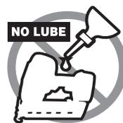
Les outils DEWALT sont correctement lubrifiés en usine et sont déjà prêts à l'emploi. Toutefois, il est recommandé d'apporter ou d'expédier l'outil une fois par an dans un centre d'assistance agréé pour un nettoyage et une inspection approfondis.
