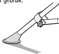
Uitzetpoot in gebruik: draaiknop in onderste positie vastzetten.
