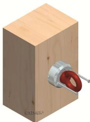
Anschliessend wird der SIHGA® IdeFix® IFS so am Holz ausgerichtet, dass die Ringschraubenöffnung im rechten Winkel zur Belastungsrichtung steht und zwei Systemschrauben (unter 90°) gesetzt. Danach wird die Ringschraube wieder herausgedreht.
