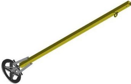
**Sekundärträger:** 40x40 Edelstahlrohr AISI 304 mit einer Dicke von 2mm und einer Länge von 170cm.
