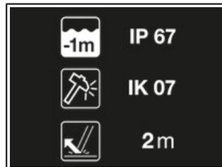
Die ARIA 1 ist staub- und wasserdicht (IP67) sowie stoßfest (IK07) und sturzfest bis 2 Meter.
