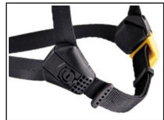
La clip del sottogola DUAL consente al lavoratore di modificare la resistenza del sottogola per adattare il casco a diversi ambienti: lavoro in quota (EN 12492) e lavoro a terra (EN 397).
