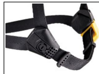
Der Clip des DUAL-Kinnbands ermöglicht es dem Benutzer, die Haltekraft des Kinnbands zu ändern, um den Helm unterschiedlichen Arbeitssituationen anzupassen: Arbeiten in der Höhe (EN 12492) und am Boden (EN 397).
