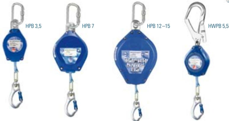
Höhensicherungsgeräte sichern von einem erhöhten Punkt aus mit einem ausziehbaren Sicherungs-Seil/-Band, welches am Auffanggurt befestigt wird. Bei einem Sturz arretiert die Vorrichtung und bremst die fallende Person weich ab, um die Fallkräfte zu begrenzen. Es sind daher keine zusätzlichen Falldämpfer erforderlich.
