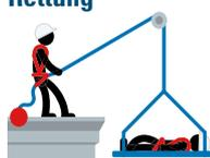
Bei Arbeiten in grosser Höhe darf der Aspekt der Rettung nicht vernachlässigt werden. Je nach Lage und Situation bedarf es für die Rettung und Bergung von Personen, welche durch ein Sturzauffangsystem aufgefangen wurden, einer speziellen Ausrüstung oder Rettungstechnik. Dieser Punkt muss bereits bei der Evaluation des geeigneten Höhensicherungs-Systems mit einbezogen werden.
