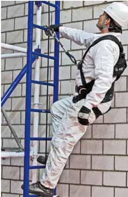
Die **horizontalen Sicherungsseile** (SSL-A, CHL) sind sowohl als Halteseile bei der Arbeitsplatz-Positionierung als auch als Rückhalteseile einsetzbar. Mit Hilfe des Seilkürzers muss die Seillänge so eingestellt werden, dass die Bewegungsfreiheit bis maximal zur Absturzkante hin ausreicht. Sie sind nicht zum Auffangen eines Sturzes konzipiert!
