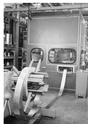
Vollkapselung eines Stanzautomaten.
