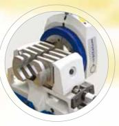
Wendespannbacken zum Bearbeiten von dünn- und dickwandigen Rohren.
