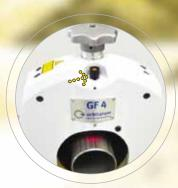
Integrierter **Strichlaser- Pointer** zur TrennstellenMarkierung auf dem Rohr.
