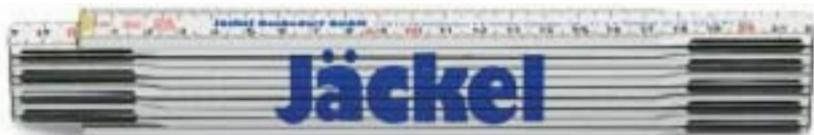
Glieder aus Buchenholz. Schutzlack auf Wasserbasis gegen Schmutz und Feuchtigkeit. Die Gelenke bestehen aus schwedischem Stahl und werden an drei Punkten geölt. Der Stahl wird wärmebehandelt und epoxidlackiert, um perfekten Korrosionsschutz zu erreichen. Ablesbarkeit der Skala vom ersten bis zum letzten Zentimeter möglich. Millimeterteilung auf beiden Seiten. Rote Dezimalzahlen. EU Klasse III.
