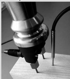
En général, on mesure le bois avec des pointes de mesure. Pour mesurer dans le bois, il convient d'enfoncer les pointes à travers la texture du bois de sorte qu'il y ait un bon contact entre les pointes et le bois.
