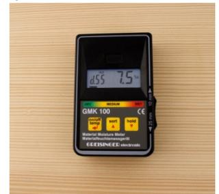
Des bois qui ne sont pas indiqués sur l'annexe A peuvent être mesurés si la densité du bois (sec) est connue: Un bois avec une densité de  $0,68 \text{ kg/dm}^3$  est mesuré avec la caractéristique de d.70 (veuillez arrondir:  $0,52 \rightarrow d.50$ ,  $0,53 \rightarrow d.55$ ).
