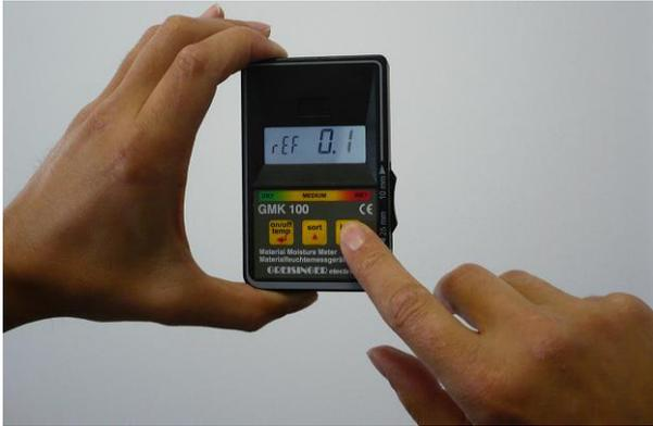
11 L'appareil doit être remis à zéro de temps en temps: Il faut tenir l'appareil à l'air comme l'indique l'image et appuyer pendant 2 sec sur "hold".
