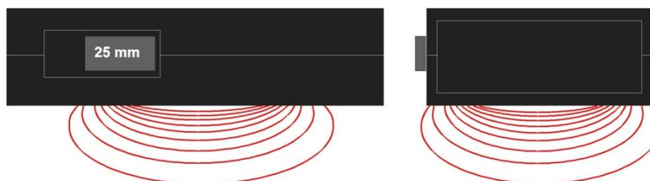
*Vue latérale: Surface de mesure et course en profondeur lors d'une position de l'interrupteur à "25 mm"*
