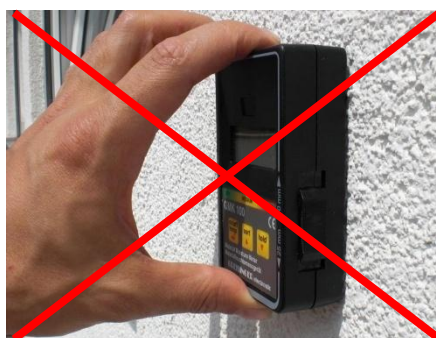
Falsch: unregelmäßige Oberfläche
