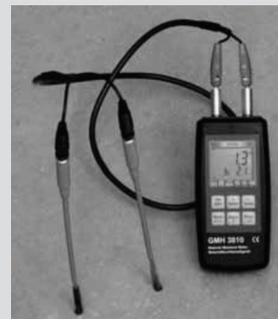
Mesure du béton avec sondes GBSL91
