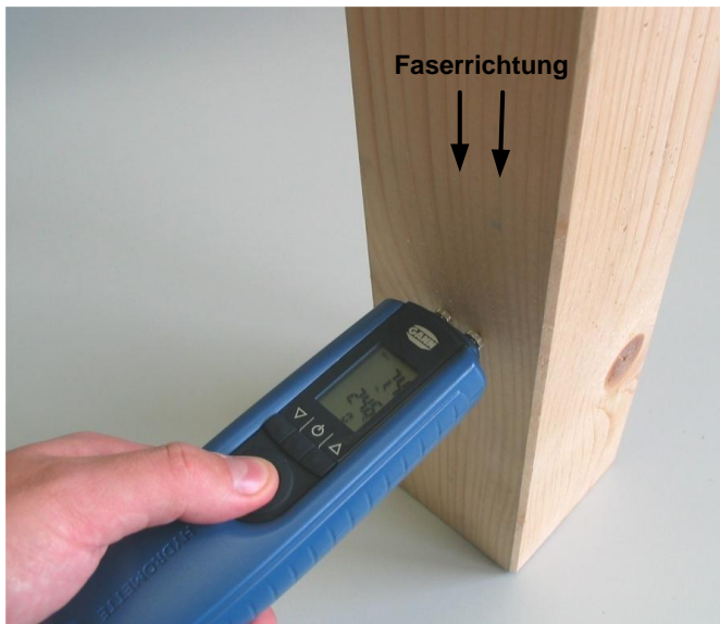
Abbildung 4-1 Messung quer zur Faserrichtung
