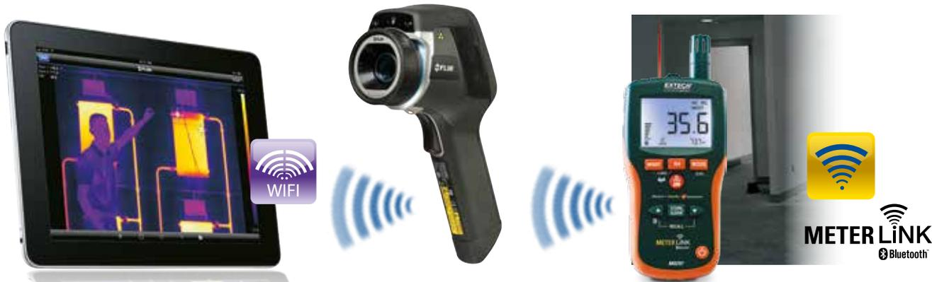
Connessione a smartphone o tablet tramite Wi-Fi, con l'applicazione FLIR Tools mobile app (Apple iOS e Android) per la gestione e la condivisione dei risultati, oltre che per il controllo remoto.
