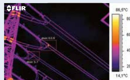
Immagine acquisita con una risoluzione di 640 x 480 pixel e sensibilità termica <45 mK. Va osservato come il punto caldo sia ora perfettamente visibile e come un numero maggiore di pixel porti ad una ancora maggiore accuratezza della lettura della temperatura nel punto caldo. Ora il problema sulla linea elettrica è chiaramente visibile.
