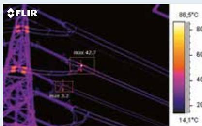
Immagine acquisita con una risoluzione di 320 x 240 pixel e sensibilità termica di 50 mK. Va osservato come un numero maggiore di pixel porti ad una maggiore accuratezza della lettura della temperatura nel punto caldo.
