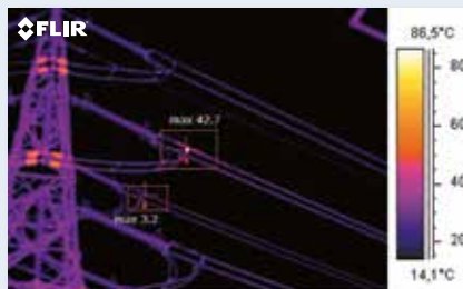
Image de 320 × 240 pixels, sensibilité thermique 50 mK. Le nombre de pixels étant plus grand, le relevé de température au point chaud gagne en exactitude.
