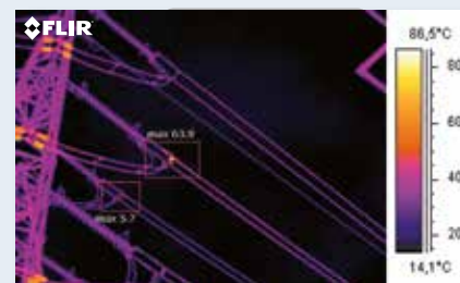
Image de 640 × 480 pixels, sensibilité thermique < 45 mK. Remarquez comme le point chaud est maintenant clairement visible. L'augmentation du nombre de pixels a encore amélioré l'exactitude du relevé de température en ce point. Il n'y a plus aucun doute sur l'existence d'un problème.
