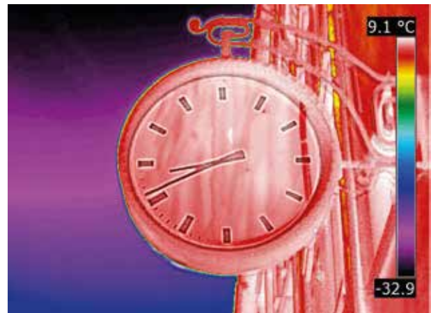
Infrarotbild mit MSX®: Obwohl Glas nicht für Infrarotstrahlung durchlässig ist, zeigt Ihnen die MSX® Funktion deutlich die Beschriftung und Zeiger der Uhr hinter dem Glas. Dies ist nur mit Hilfe der MSX®-Technologie möglich, welche einen Teil des Digitalbildes mit dem Infrarotbild vereint. Das Ergebnis: Infrarotbilder auf denen selbst kleinste Details sichtbar werden.
