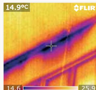
L'immagine ad infrarossi mostra un'infiltrazione di aria fredda nell'edificio causata da un cattivo isolamento del soffitto.
